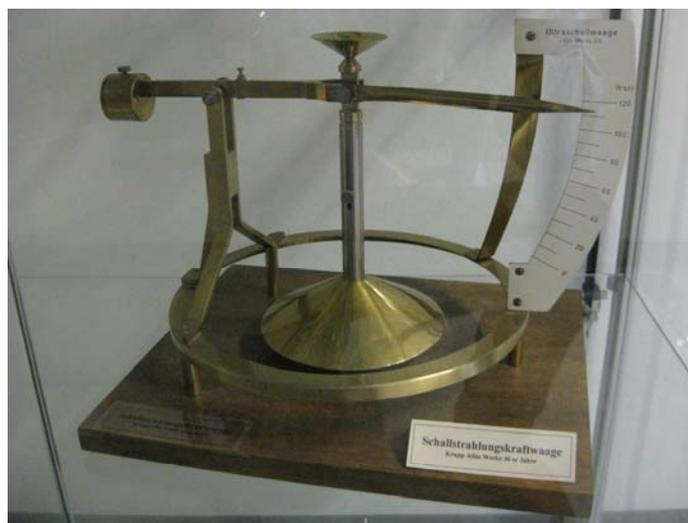
Fig 6. 1930s Radiation-force balance of Atlas-Werke, Bremen. Physikalische-Technischen Bundesanstalt, Braunschweig.
